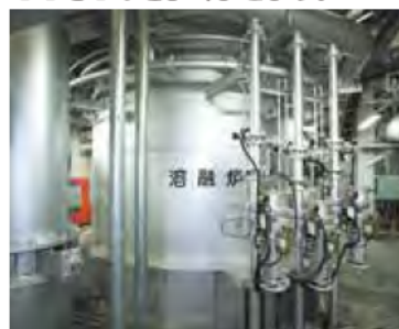
溶融炉 ゴミを高い温度で溶かしてドロドロにします。
