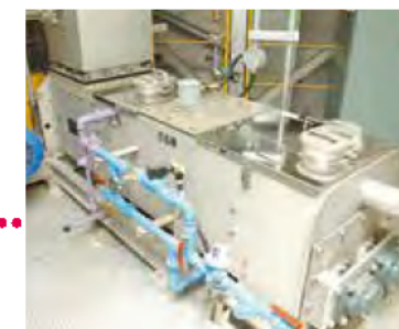
集じん灰処理装置 灰に薬品を加えて、固めて無害にします。
