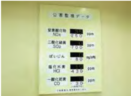
■排ガス表示盤 排ガス中のばいじん及び各種ガスはリアルタイムに測定値が濃度計算され、表示されます。
